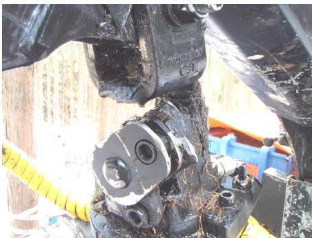
破断したローテータ
